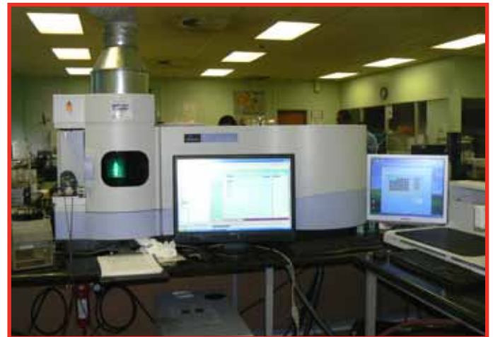
Ao analisar amostras de óleo, o espectrómetro ICP (plasma de acoplamento induzido) fornece dados, como os níveis de contaminação e desgaste, que podem ser usados como parte de um diagnóstico holístico da amostra
